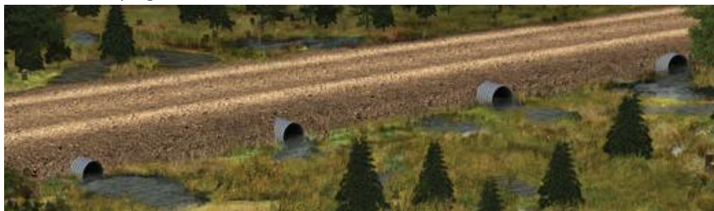
Joonis 16. Truupide kasutamine muutliku veerežiimiga märgaladele teede ehitamisel 35 .
