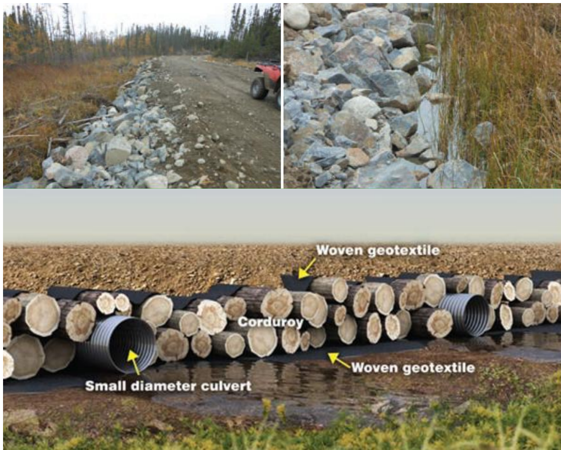
Joonis 17. Vett läbilaskva materjali ja truupide kombineeritud lahendused märgaladele teede ehitamisel 35 .
